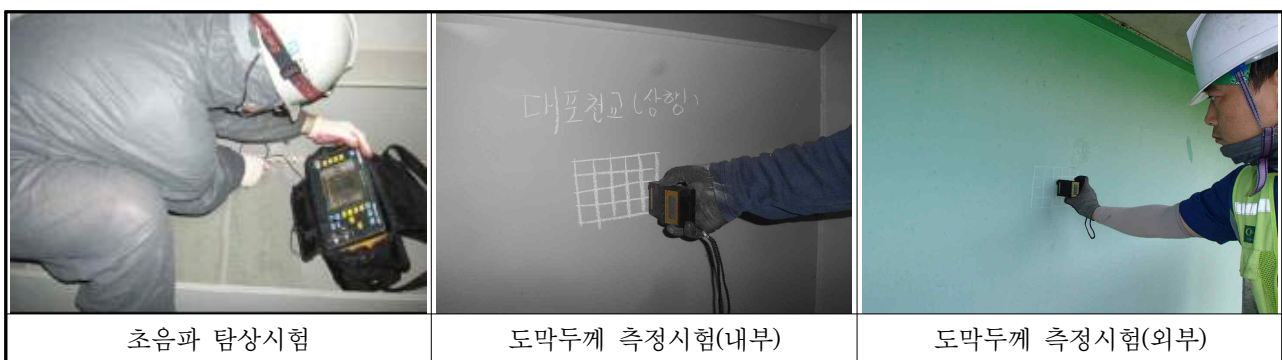
【사진 3.5.1】 강재 비파괴시험 전경
