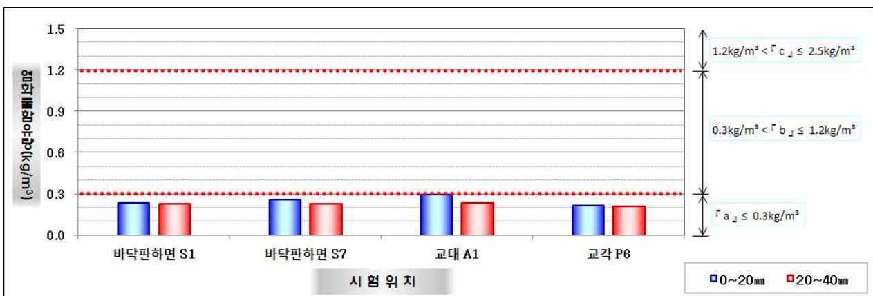
【그림 3.4.14】 염화물시험 측정결과(대구)
