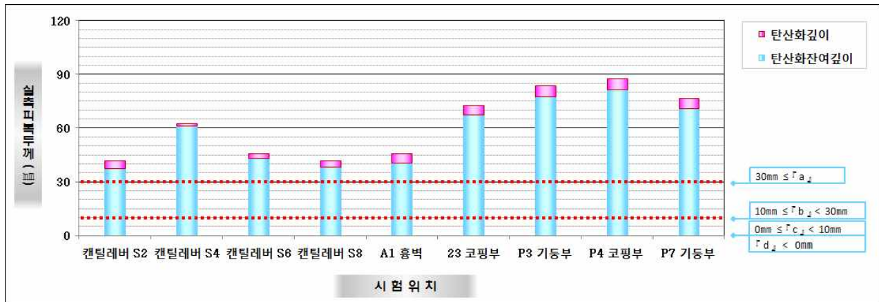
【그림 3.4.17】 탄산화 깊이 측정결과(부산)
