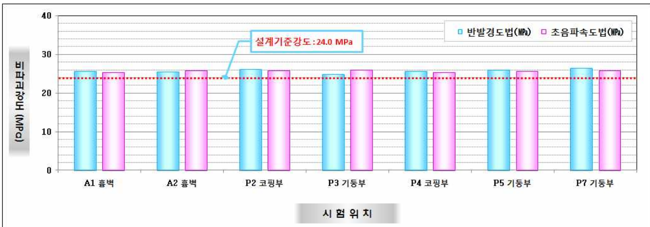
【그림 3.4.16】하부구조(교대, 교각) 평균압축강도 추정결과(부산)
